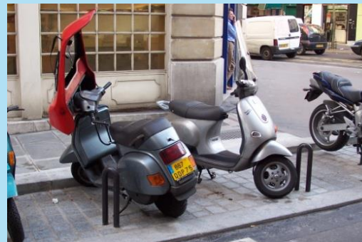
À gauche, des épingles basses, utilisables uniquement par des 2RM ; à droite, des arceaux vélos aux espacements trop étroits pour que les 2RM puissent s'y installer.
