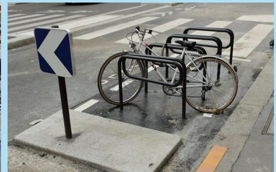
À gauche, des épingles basses, utilisables uniquement par des 2RM ; à droite, des arceaux vélos aux espacements trop étroits pour que les 2RM puissent s'y installer.
